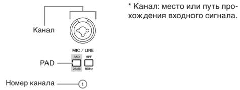
**ПРИМЕЧАНИЕ** При использовании конденсаторных микрофонов включите переключатель [PHANTOM +48V].
